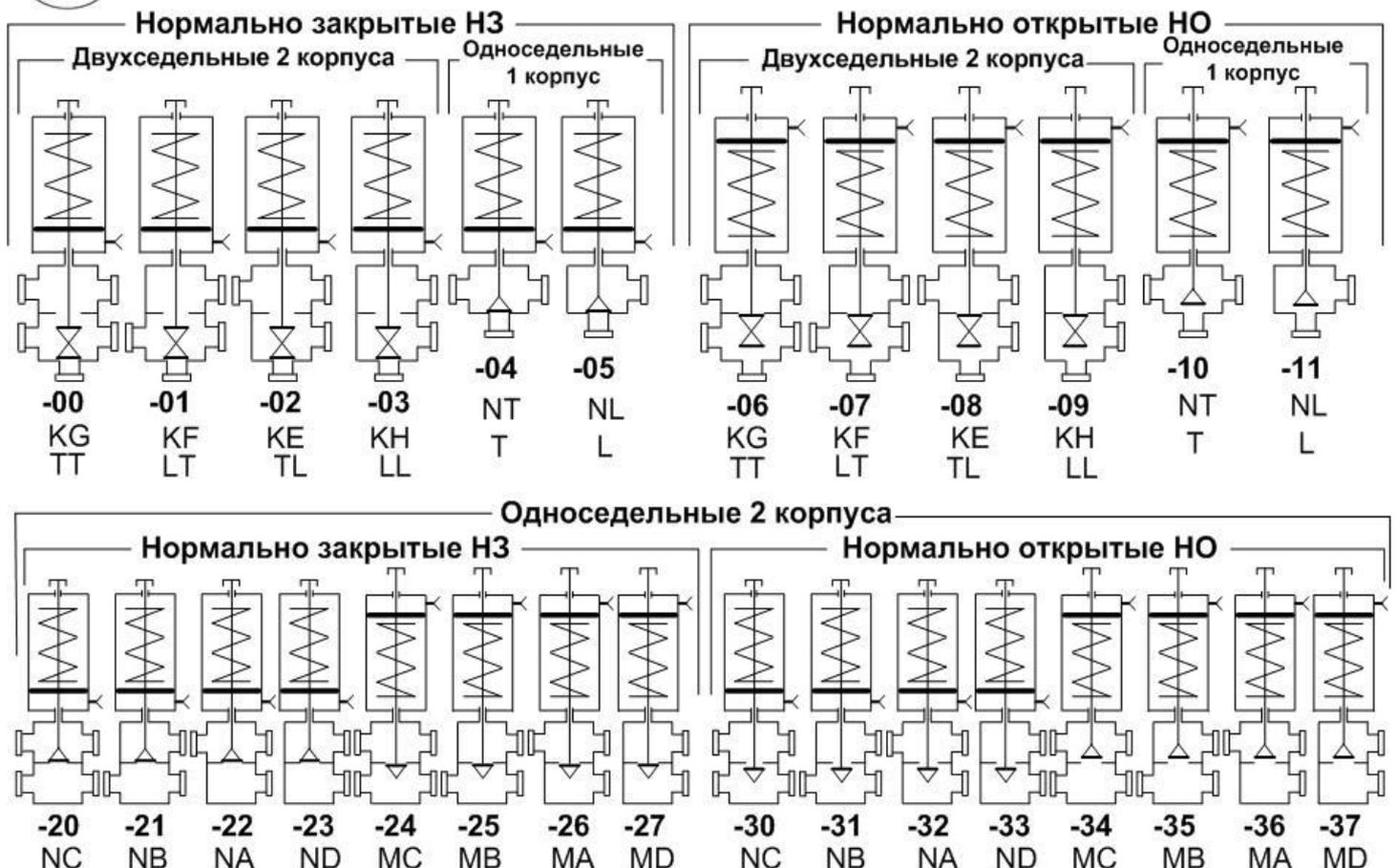
Сокращённое обозначение клапана по типу присоединения к трубопроводу Ду32 (д35х1,5), -S - приварное, -М - муфтовое.
